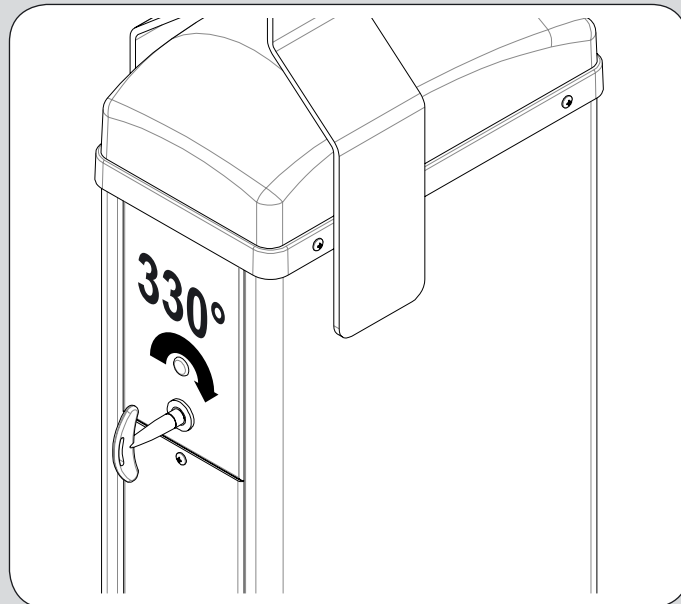
Dann den Schlüssel um 330° drehen, so dass das Tor von Hand bewegt werden kann.
